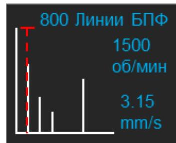
Нажатием кнопки со стрелкой вниз разрешение оси частот повышается со 100 линий (т. е. с 10 Гц или 600 об/мин) до 800 линий (т. е. до 1,25 Гц или 75 об/мин). С увеличением разрешения практически **расширяется** спектр частот. Отображение всего спектра частот с повышенным разрешением выполняется **прокруткой** индикации кнопкой со стрелкой влево или кнопкой со стрелкой вправо .
