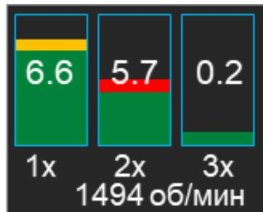
Указание. Для анализа вибраций важно, чтобы правильно была введена скорость вращения агрегата (с помощью «мастера установки», см. раздел 3.5.1 данного руководства по эксплуатации, или с использованием стробоскопической насадки, см. раздел 6.1).
