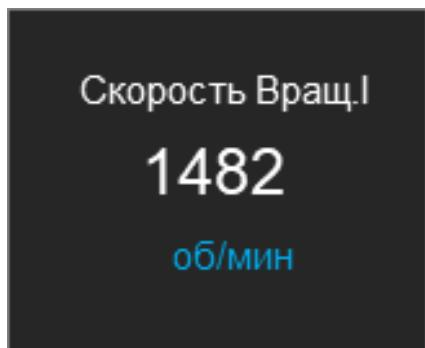
Если выбран мастер установки, открывается диалог, в котором можно ввести скорость вращения агрегата. Она требуется для автоматической настройки уровней сигналов тревоги ISO в зависимости от мощности и типа контролируемого агрегата.
